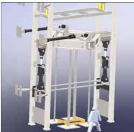
Montage d'essais pour sections de pylônes de transport d'énergie électrique.
